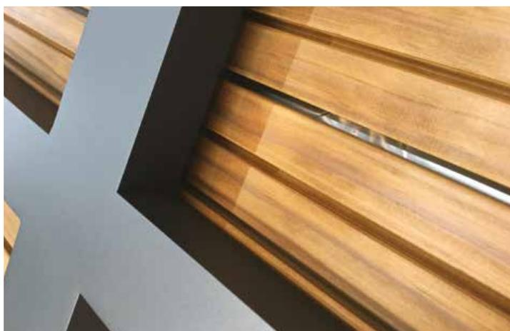
L'essence de bois est du pin thermo-traité. Le pin est chauffé au moins à 215°C lors du traitement thermique et la vapeur est utilisée pour éviter les fentes et les fissures pour un résultat comparable au bois dur exotique de la classe I/II. Le bois est sans nœud (excepté pour le modèle Greenwich) et les 4 faces sont lisses et ont des angles arrondis..
